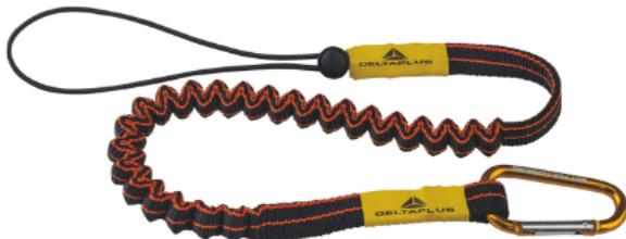
Строп для страховки инструмента. Состоит из эластичного ремня шириной 16 мм, шнура с фиксатором и карабина. Максимальная длина устройства - 1 м. Максимальный вес прикрепляемого инструмента - 4 кг. Аксессуар крепится к привязи с помощью карабина.
