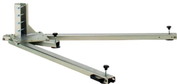
Мобильное напольное крепежное основание для анкерного устройства GIRAFE TRG20. Представляет собой конструкцию из пластины с посадочным местом, прикрепленную к трем опорным ножкам, две из которых раздвигаются на угол 45°. Возможность выравнивания всей конструкции в горизонтальной плоскости с помощью регулировки высоты ножек. Компактность в сложенном виде, легкость и удобство транспортировки. Быстрый и простой монтаж – демонтаж.
